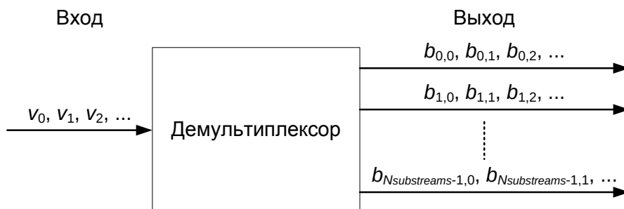
Рисунок 5 – Демультиплексирование потока битов на подпотоки
